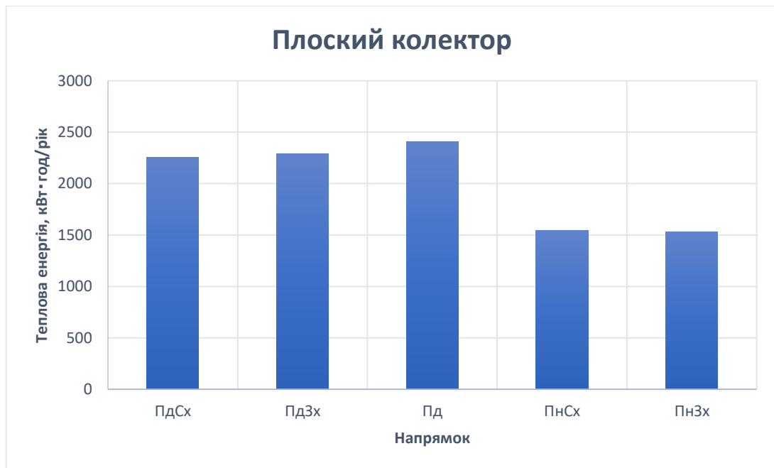
Рисунок 5.12- Залежність теплогенерації від орієнтації СК.
