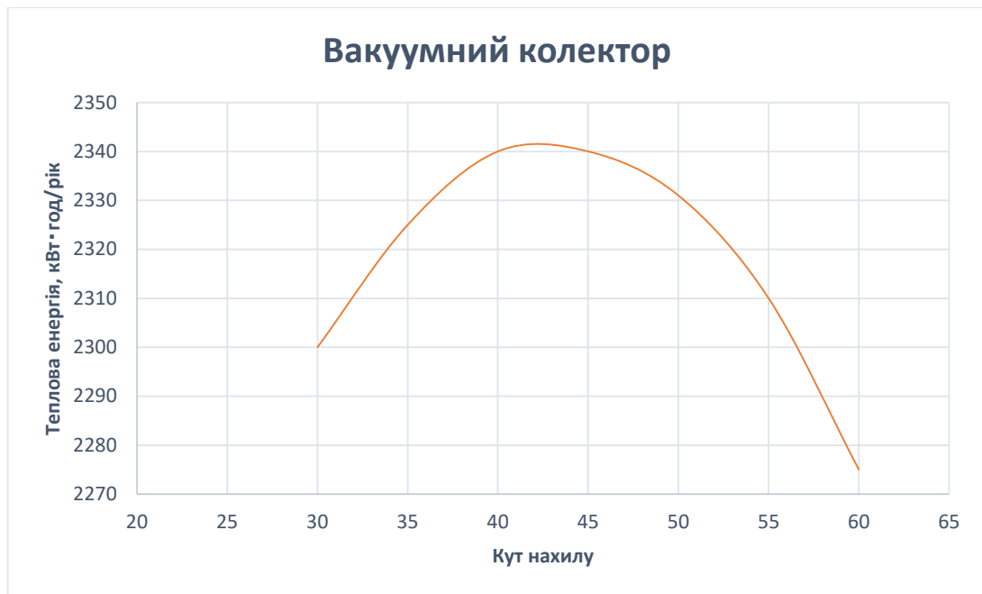
Рисунок 5.10 – Залежність теплової генерації від кута нахилу вакуумного колектора
