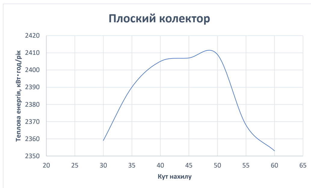
Рисунок 5.9 – Залежність теплової генерації від кута нахилу плоского колектора
