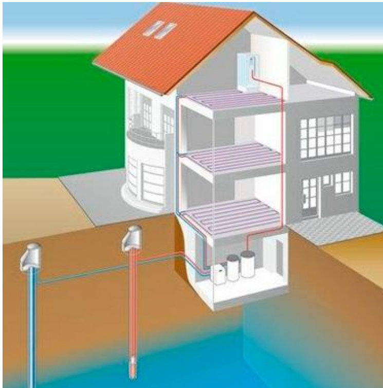
Рисунок 2.2 – Грунтові води як джерело тепла
